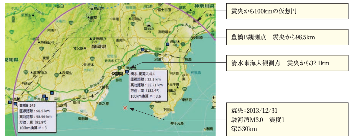
図10 震央からの距離による100km換算M値の差(豊橋:ほぼ100kmでM3.0 清水:はほぼ30kmで100km換算M3.6)
