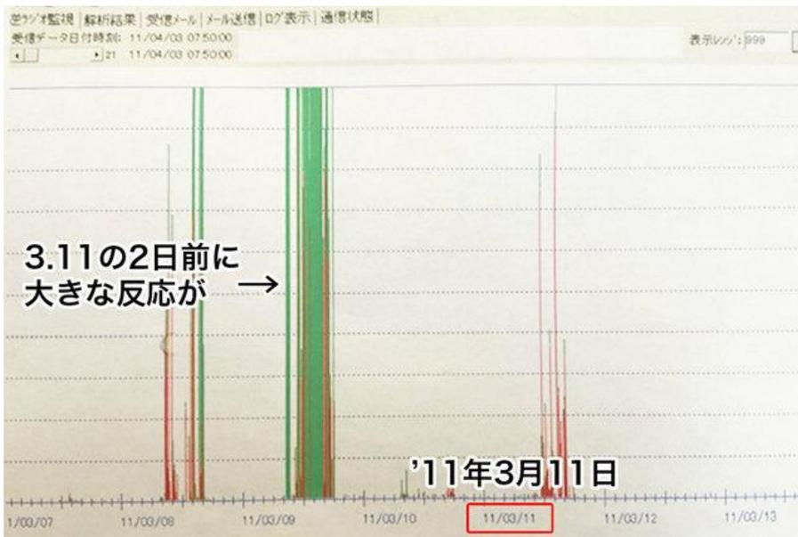
2011年3月9日14時30分ごろにノイズが瞬間的に発生した。3月11日の地震が起きたタイミングも、ノイズが発生していた
